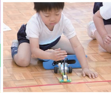
⑧モーションボタンセンサーを設定。 車の前で手を上下するとスタートするよ。
