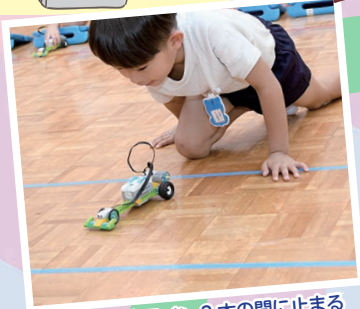
⑦ゴールの青ライン2本の間に止まるように、パワーの数字を変えながら試してみる。
